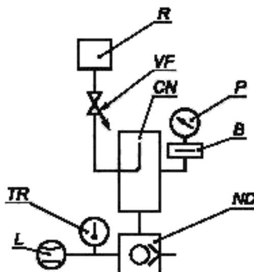
*CN* — измерительная камера; *ND* — испытуемый насос; *P* — вакуумметр; *B* — охлаждаемая ловушка; *VF* — клапан-напекатель; *R* — устройства для измерения потока; *L* — измеритель расхода воды; *TR* — датчик измерения температуры
